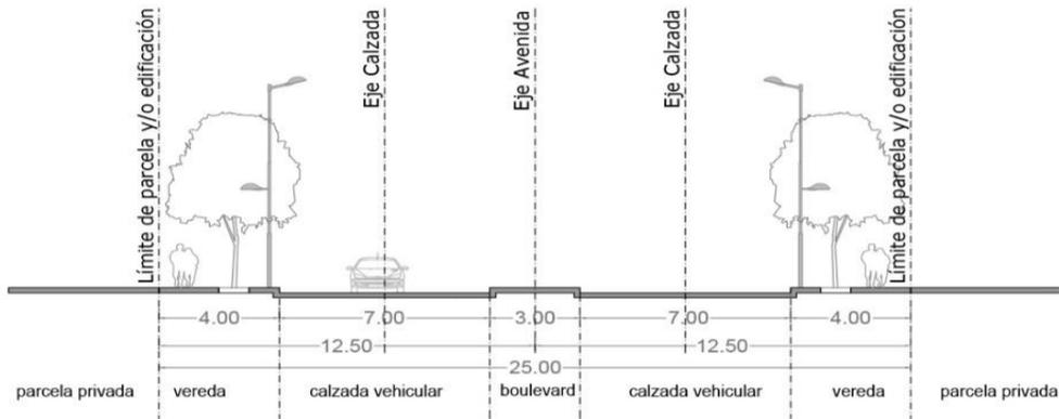
Fig. 8: Sección transversal de Vías Avenidas Tipo 5.
