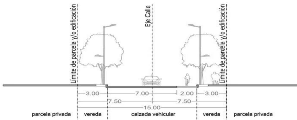
Fig. 18: Sección transversal de Vías Especiales Tipo 4.
