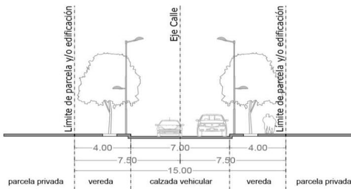
Fig. 13: Sección transversal de Vías Calles Tipo 10.
