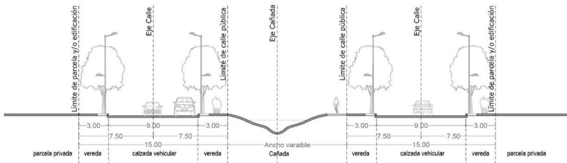
Fig. 16: Sección transversal de Vías Especiales Tipo 3.
