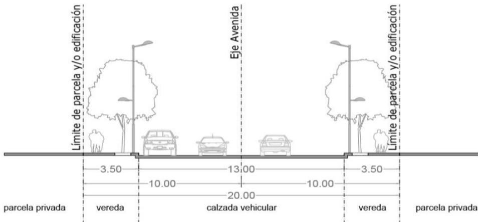
Fig. 9: Sección transversal de Vías Avenidas Tipo 6.
