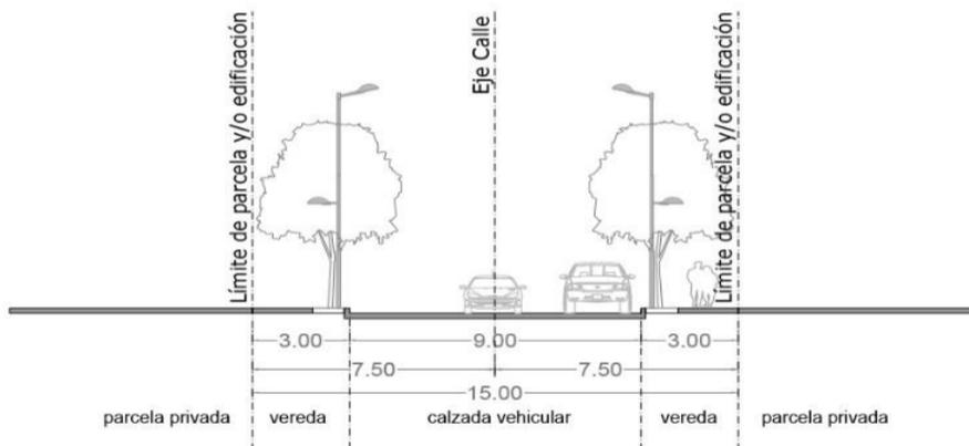
Fig. 12: Sección transversal de Vías Calles Tipo 9.
