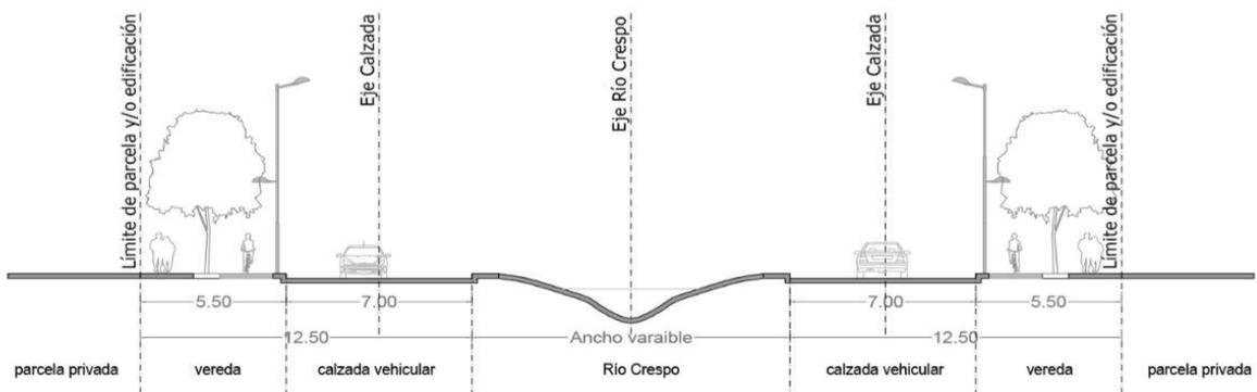
Fig. 17: Sección transversal de Vías Especiales Tipo 4.
